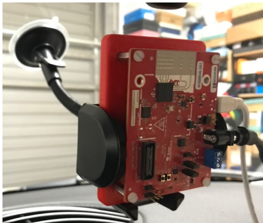
Figura 2.18. Il·lustració de la situació del RADAR per l'aplicació de detecció de l'ocupació a l'interior d'un vehicle.
